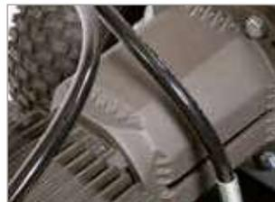
ACOPLAMIENTO FLEXIBLE ENTRE BOMBA Y MOTOR PARA PROLONGAR LA VIDA ÚTIL DE LOS COMPONENTES (VERSIÓN "H")
