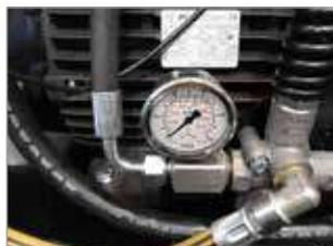
MANÓMETRO PROFESIONAL PARA LA MEDICIÓN CONSTANTE DE LA PRESIÓN DE FUNCIONAMIENTO
